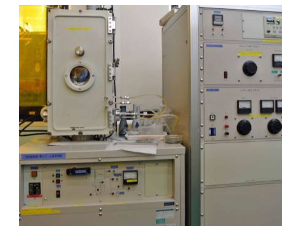
【成膜】 EB蒸着装置 (サンユー電子)
